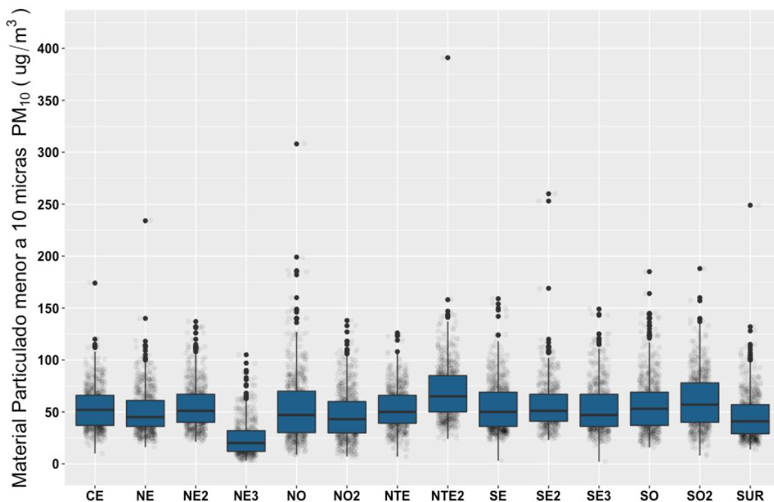
**Figura 17. Distribución horaria del Material Particulado menor a 10 micrómetros (PM<sub>10</sub>) en las estaciones del SIMA**
