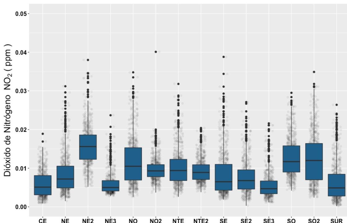
**Figura 31. Distribución horaria del Dióxido de Nitrógeno (NO<sub>2</sub>) en las estaciones del SIMA**
