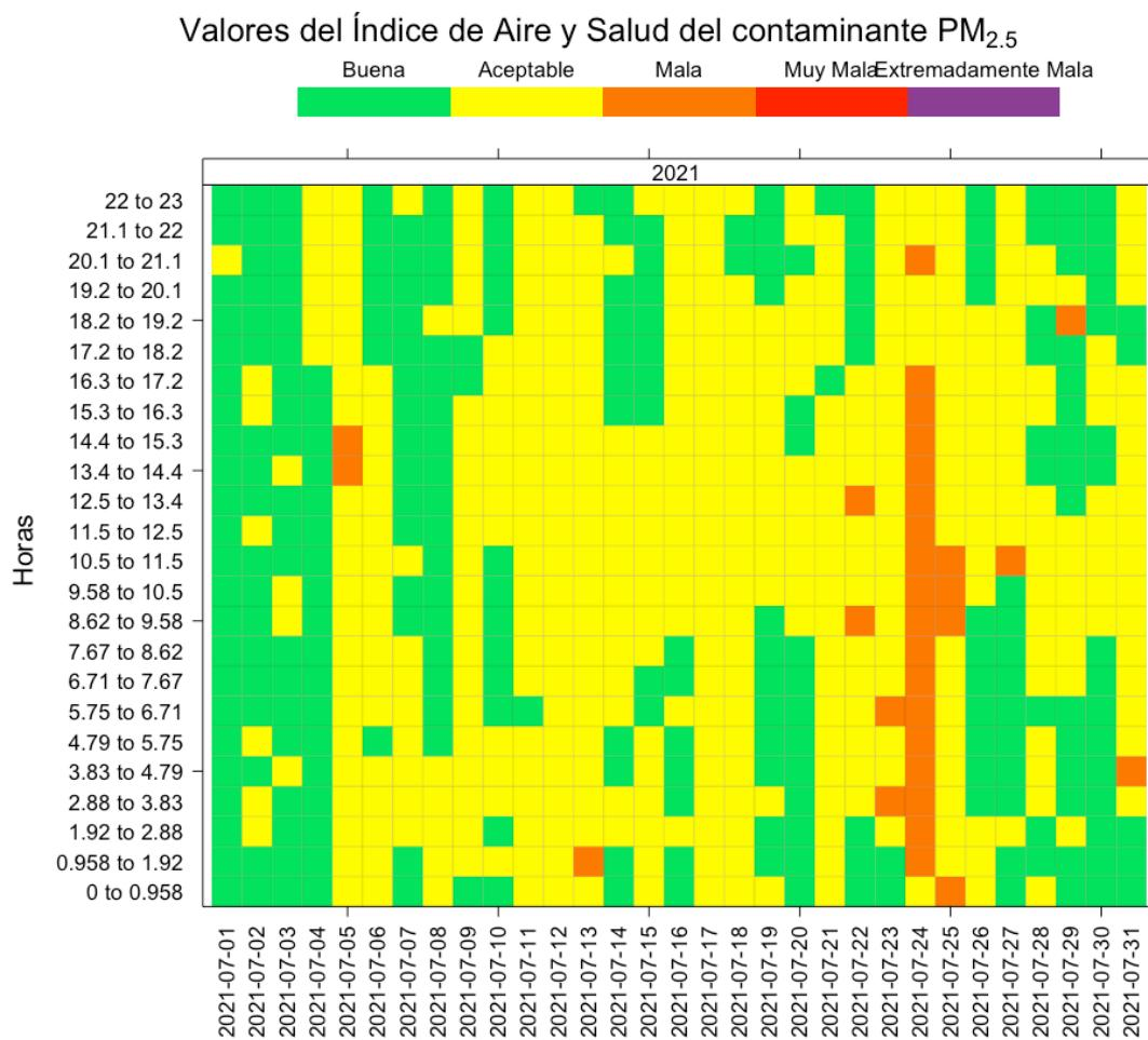
**Figura 21. Distribución horaria global para el índice de aire y salud del Material Partículado menor a 2.5 micrómetros (PM<sub>2.5</sub>)**
