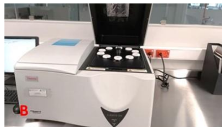
Figura 5. Equipos analíticos para el análisis de muestras de partículas (A) Ultramicrobalanza para determinación de masa, (B) Equipo de análisis elemental por fluorescencia de rayos X, (C) Cromatógrafo de iones para análisis de aniones y cationes y (D) Analizador de carbono por termorreflectancia óptica.
