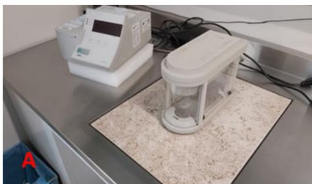
Figura 5. Equipos analíticos para el análisis de muestras de partículas (A) Ultramicrobalanza para determinación de masa, (B) Equipo de análisis elemental por fluorescencia de rayos X, (C) Cromatógrafo de iones para análisis de aniones y cationes y (D) Analizador de carbono por termorreflectancia óptica.
